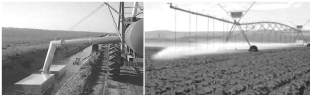
Рисунок 1 – Дождевальные машины Linestar и Centerliner (с круговым типом движения) с программой управления поливом, «Bauer GmbH», Австрия
