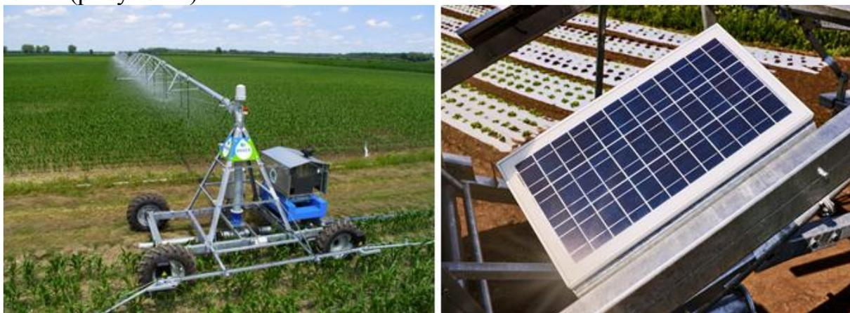
**Рисунок 2.** Солнечные панели Solarpanel\_PA210046, установленные на машине Rainstar (Австрия)
