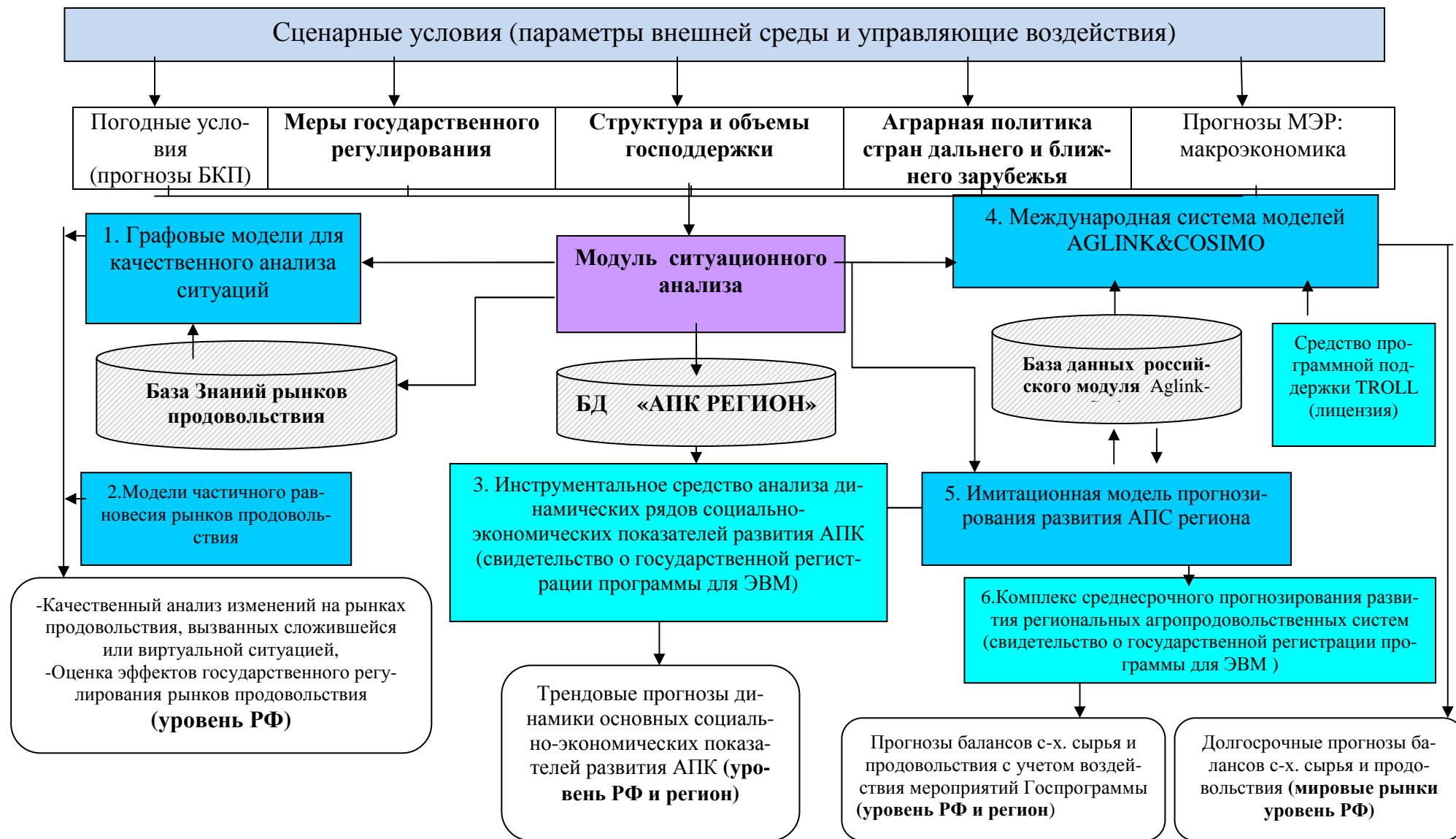
Рисунок 1- Блок схема комплекса моделей для поддержки информационных технологий ситуационного анализа в АПК России
